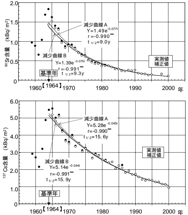
図16 水田作土からの<sup>90</sup>Srと<sup>137</sup>Cs含量の減衰表11 水田作土における<sup>137</sup>Csと<sup>90</sup>Srの滞留半減時間(年)
