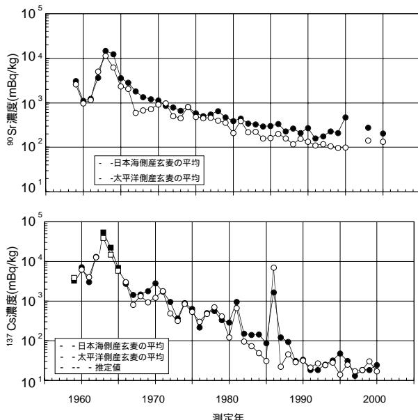
図7 日本海側産玄米と太平洋側産玄米における<sup>90</sup>Srと<sup>137</sup>Cs濃度の経年推移（全国平均）
