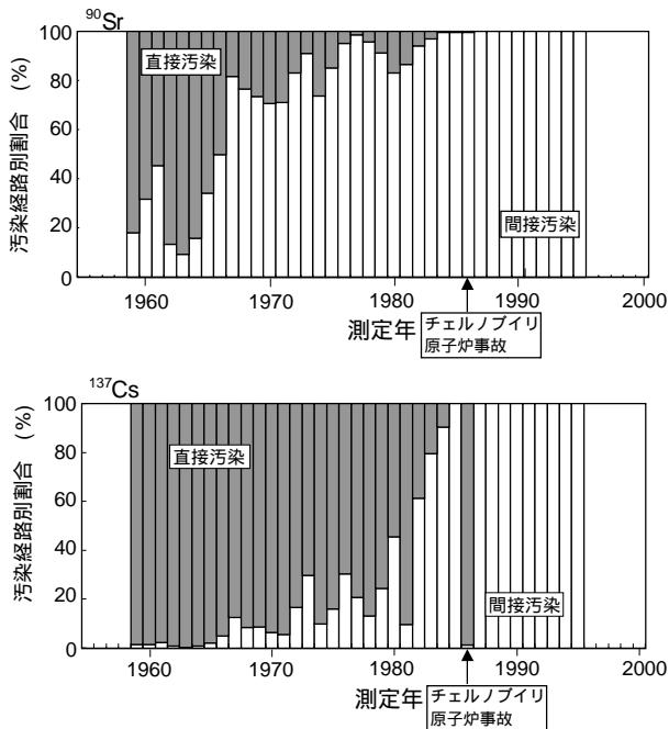
図15 玄米の<sup>90</sup>Srと<sup>137</sup>Cs汚染経路割合とその経年変化(2) 水田・畑作土の<sup>90</sup>Srと<sup>137</sup>Csの滞留半減時間
