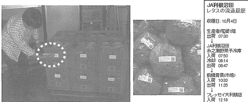
図4 群馬県レタスの実証試験における、商品を入れたコンテナに添付したICタグを読み取る様子(左)、二次元コードのラベルを貼付した商品(中)、携帯電話での流通履歴の表示イメージ(右)
