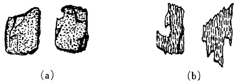
第1図 普通輝石の溶蝕 (a) ほとんど溶蝕をうけない粒子 (b) 溶蝕の著しい粒子
