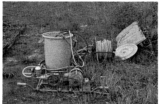
第1図 弱毒ウイルス接種に使用された動力噴霧機(静岡農試)。真中のタンクは弱毒ウイルス保毒汁液を入れる。噴口は7個あり、右端のコックのある方をもち噴霧しながら移動する。そのため長いホースがリールに巻かれている。
