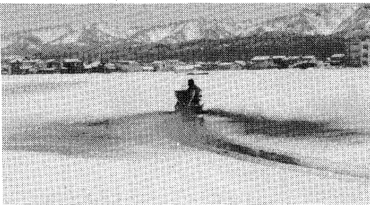
第7図 スノーモビル+ブロードキャスタ方式による散布
