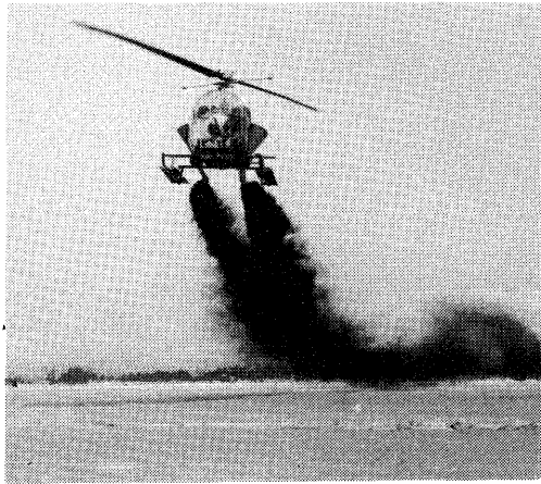
第5図 ヘリコプターによる融雪材(カーボンブラック)散布
