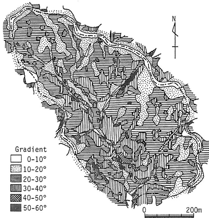
Fig. 4 試験流域の傾斜区分図
