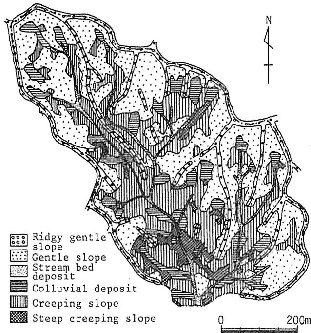
Fig. 6 試験流域の微地形分類図
