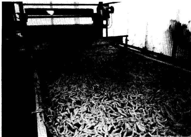
第12図 熟蚕収集状況 (コンベヤ蚕座から熟蚕収集コンベヤへ)
