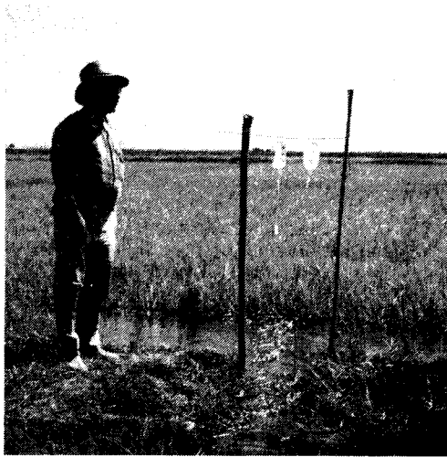
第1図 水口におけるエトフェンプロックス4%水面展開剤滴下装置
