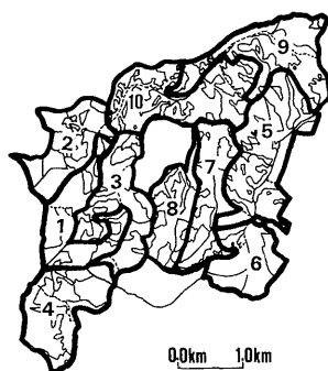
図-11. 計画対象森林の伐区および伐採順序案 (その 1) Cutting area and cutting course plan (Example 1)
