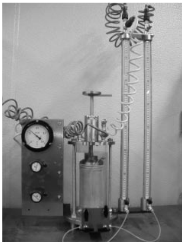
Photo 1 三軸セルを用いた透水試験機の例（F-TP75Mk. 型）
