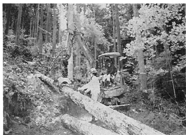
写真-5 グラップルローダとチェーンソーによる玉切り
