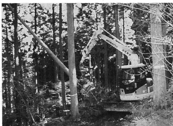
写真-6 ハーベスタ (8tクラス) による伐採
