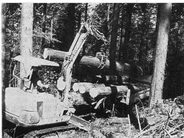
写真-2 グラップルローダ (3tクラス) とフォワーダ
