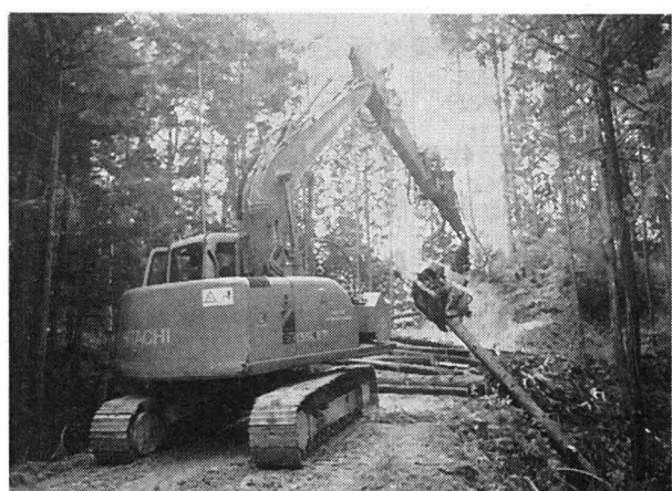
写真-3 プロセッサ搭載スイングヤード
