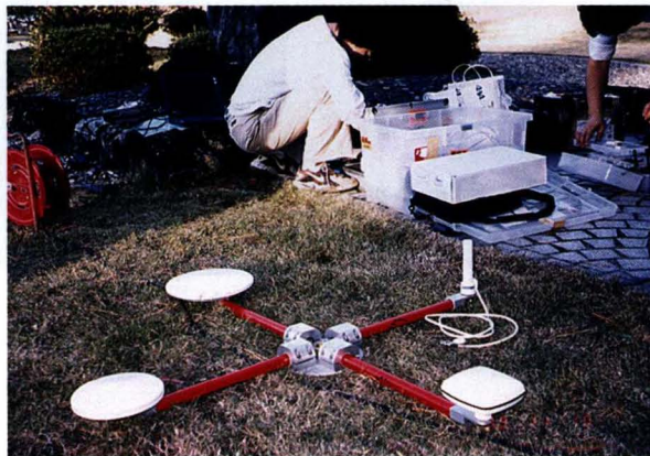
図2-8 アンテナ設置用ステー
