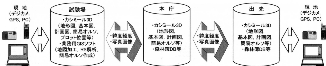
図5-15 カシミール3Dを核としたデータ交換のイメージ
