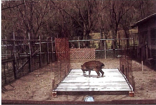
鉄管隙間80mm 鉄管遊動幅: max=57.0mm
