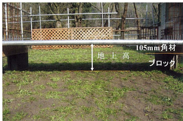
第6図 通過可能最低地上高試験
