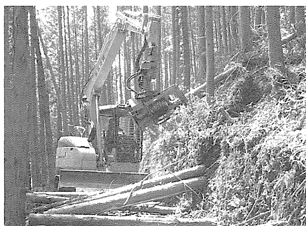
写真2 残存木に配慮しながら造材するハーベスタ
