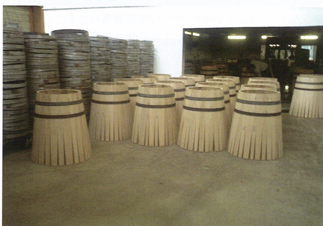
写真13 片側が組み上がった樽
