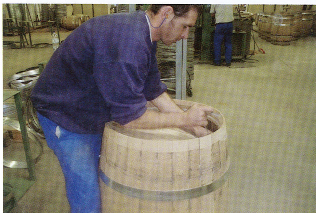
写真20 鏡板のはめ込み作業
