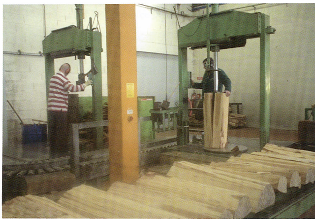
写真6 樹皮はぎと割りの工程
