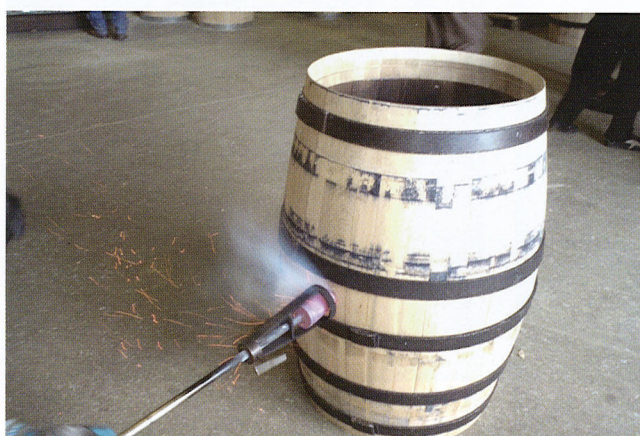
写真19 側面への穴あけ作業
