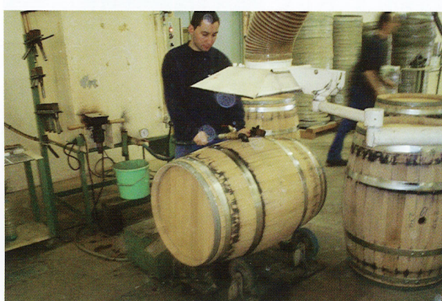
写真21 温水と加圧による漏れ試験
