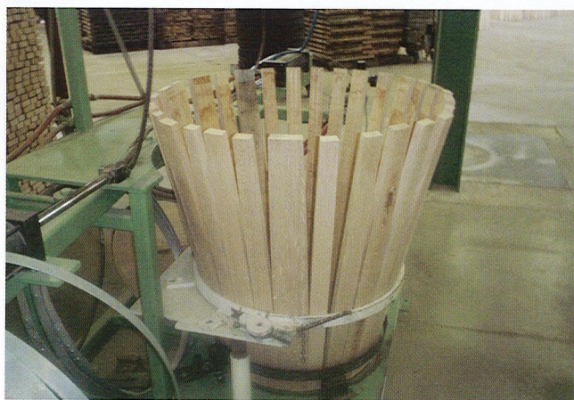
写真12 樽の形状へ組み立てられる樽板
