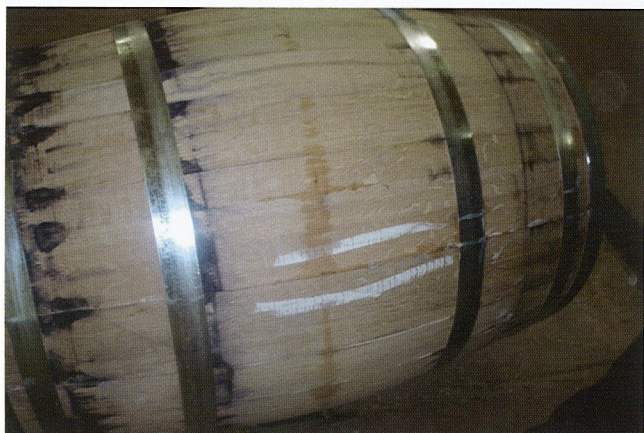
写真22 中央付近から漏れが見つかった樽
