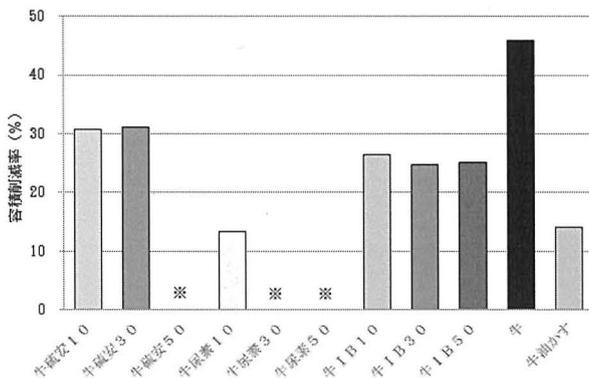
図3-2 造粒時の容積削減率(牛)
