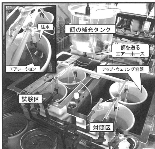
図 1 試験区および対照区の飼育設備の概要
