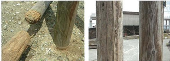
写真2 耐久性及び耐候性試験10年経過 (各写真において左: 素材, 右: 低分子フェノール樹脂処理木材)
