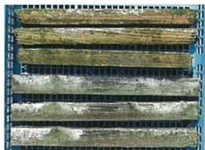
写真3 飛沫帯8年目の試験体(上3体コントロール材, 下3体低分子フェノール樹脂処理木材)
