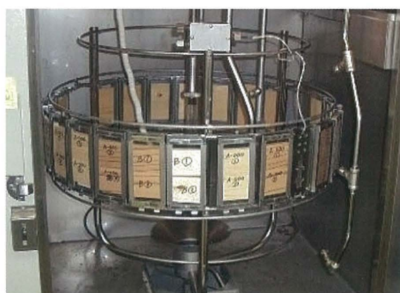
写真4 促進耐候性試験（キセノンランプ法）
