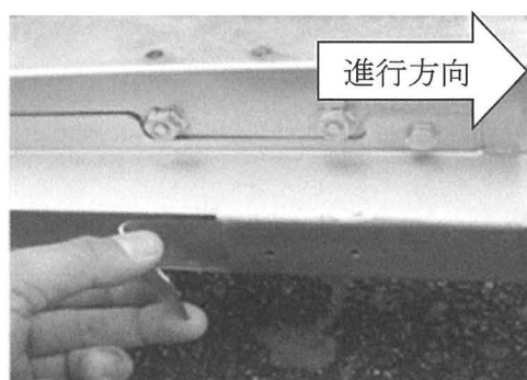
A 「補助溝切り器」を「溝切り器」の底に差し込みボルトで固定する
