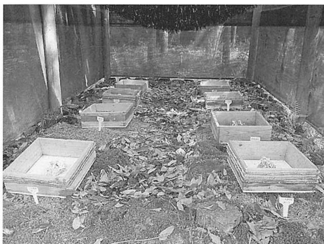
第3図 銅素材のナメクジに対する忌避効果試験用木枠の設置状況
