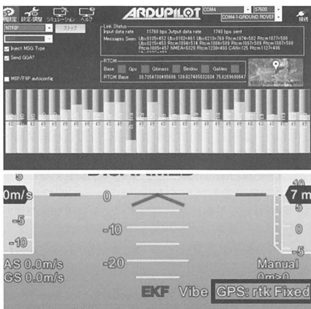
図 3 基準局の衛星捕獲状況 (NTRIP Caster 経由) (上図) と RTK-Fix になった時の様子 (下図)
