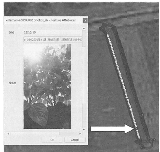
図 6 自律走行ロボットの走行記録とエダマメ圃場で撮影した画像を GIS へアップロードした様子
