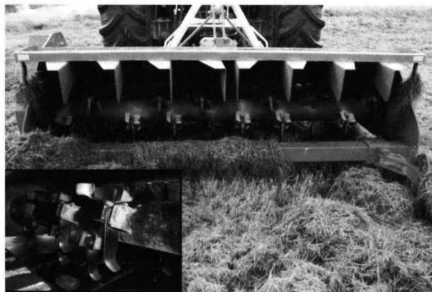
写真 1. ストローチョッパーの構造.
