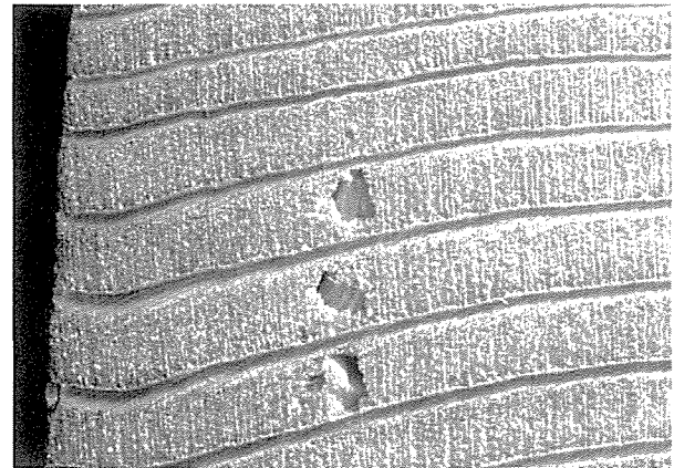
図14 スギ木口切断面に出現した早材部の陥没 (貫入部から3mm付近)
