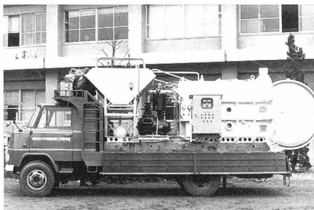
図 1 1965 年開発の移動式真空冷却装置 （提供：鹿児島大学農学部食料環境システム学研究室）
