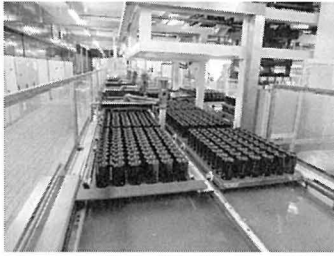
第38図 大手メゾンにおけるデゴルジュマン・ドザージュライン(瓶口を凍結させるライン)
