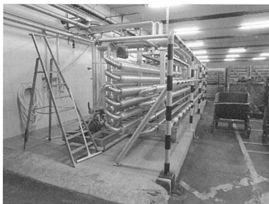
第4図 サーマ・ヴィニフィケーション装置(大手メ ゾンにて)
