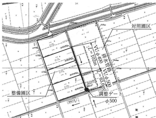
図-2 「ハイパー田んぼダム」実証工区 平面図
