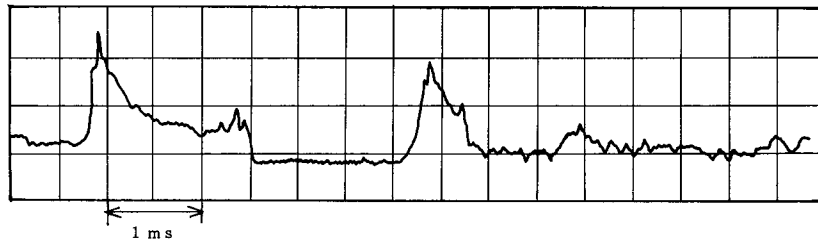
図4-6 発音筒宙吊り爆発のさいの圧力波型 (トランジェントXYレコーダーによる記録)
