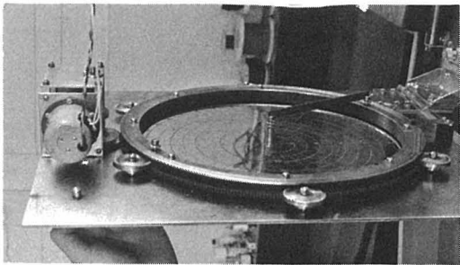
図 2-8 方向指示電極の取付け情況
