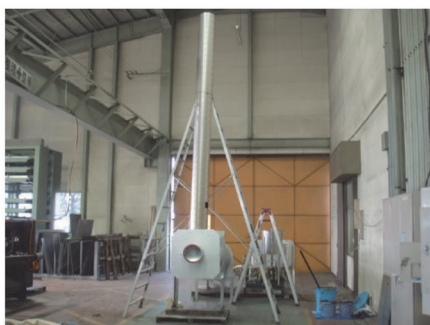
図 41-1 バイオオイル燃焼システム（全体）
