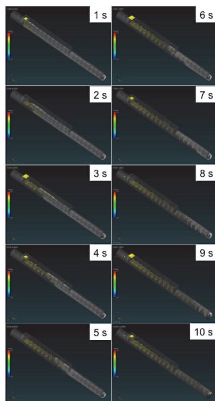
図 12-3 鉄球充填量が多い場合の粒子搬送挙動
